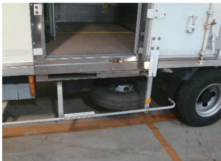
■図3/サイドバンパー上に設置されたサイド部のステップ (左:地面から見た様子、右:荷台(庫内)から見下ろした様子)
