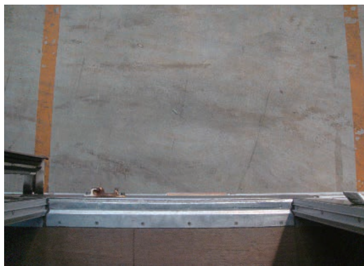
■図3/サイドバンパー上に設置されたサイド部のステップ (左:地面から見た様子、右:荷台(庫内)から見下ろした様子)
